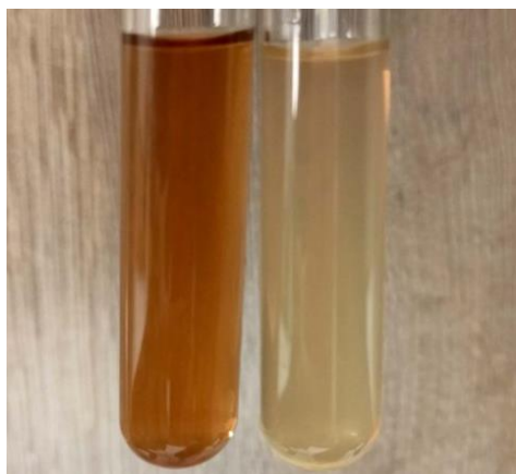
شکل ۱- تغییر رنگ محلول نیترات نقره و تشکیل نانوذره نقره سنتز شده از عصاره آبی آرد بلوط
