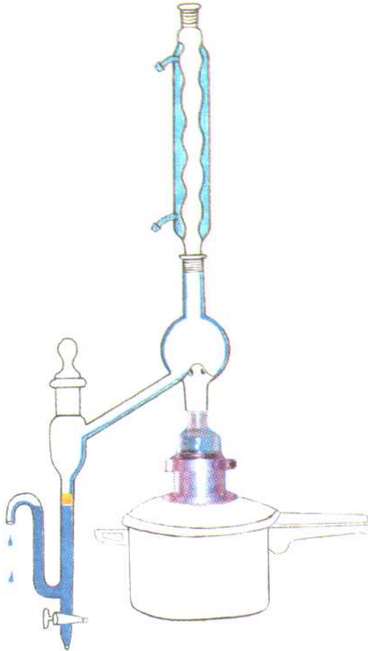
شکل شماره ۱- استخراج اسانس با روش تقطیر با آب
