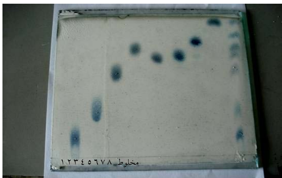
شکل ۲- لکه‌های تشکیل شده در صفحه کزل گور G (به دو حالت جداگانه و مخلوط استاندارد)
