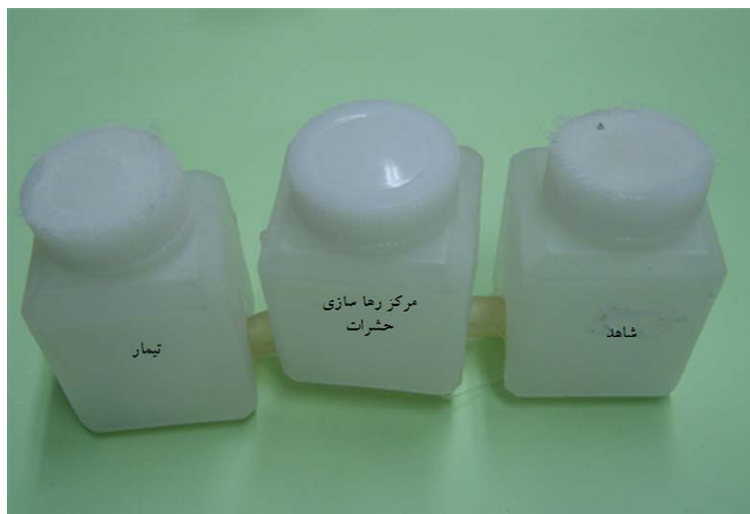
شکل ۲- شکل اصلی ظرف‌های آزمایش اثر دورکنندگی اسانس معمولی و اسانس نانوکپسوله (ظرف وسط محل رهاسازی حشرات با درب بسته و ظروف طرفینی مربوط به تیمار و شاهد که با توری پوشانده شده‌اند.) (قابل تهویه)
